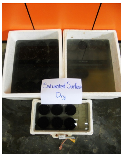
รูปที่ 6.4 ก้อนตัวอย่างที่เก็บจากสนามนำไปทดสอบหาค่าความแน่นเพื่อหาค่าควบคุมการบดทับในสนาม
