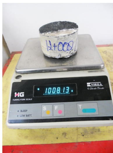
รูปที่ 6.4 ก้อนตัวอย่างที่เก็บจากสนามนำไปทดสอบหาค่าความแน่นเพื่อหาค่าควบคุมการบดทับในสนาม
