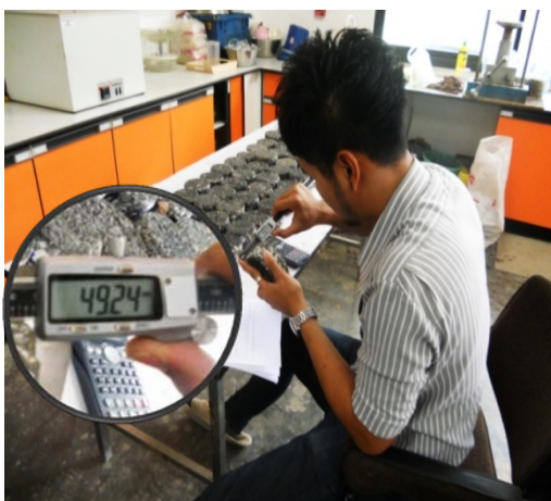
รูปที่ 6.8 การตรวจวัดความหนาก้อนตัวอย่าง และการปรับแต่งผิวหน้าหนาก้อนตัวอย่าง
