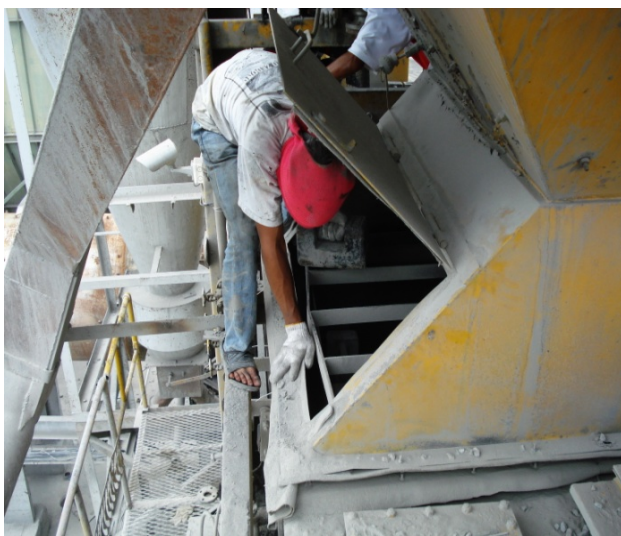
รูปที่ 2.13 การวางตุ้มน้ำหนักเพื่อตรวจสอบเครื่องชั่ง
