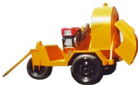
รูปที่ 3.10 เครื่องเป่าลม (Blower)
