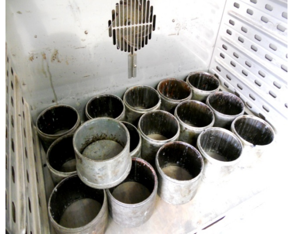
รูปที่ 1.5 ให้ความร้อนมวลรวมที่อุณหภูมิ 163 \pm 8^{\circ}\text{C} และอุ่นแบบบดอัดเตรียมไว้
