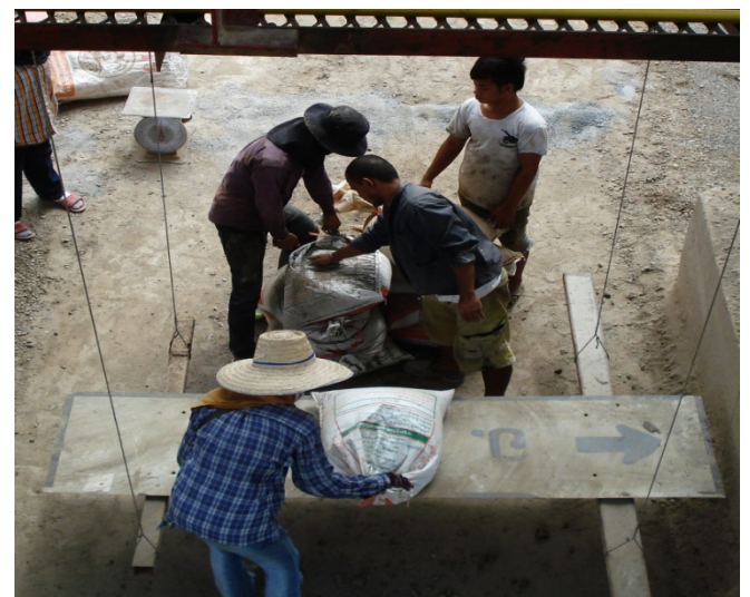
รูปที่ 2.14 กรณีที่ใช้วัสดุอื่นแทนตุ้มน้ำหนักมาตรฐาน
