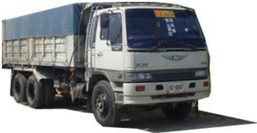
รูปที่ 3.1 รถบรรทุก (Haul Truck)
