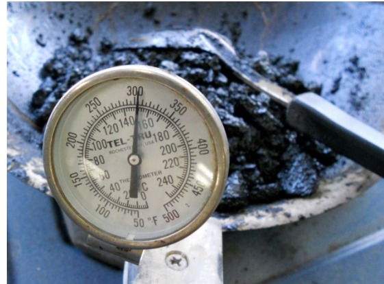
รูปที่ 1.7 คลุกเคล้าส่วนผสมร้อนให้เข้ากันโดยควบคุมอุณหภูมิให้อยู่ระหว่าง 121-163 °C ใช้เวลาประมาณ 1 นาที นำไปบดอัดในแบบเตรียมก้อนตัวอย่างตามวิธีมาร์แชลล์
