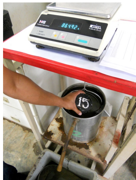
รูปที่ 1.13 ทดสอบหาค่าความถ่วงจำเพาะและความแน่น
