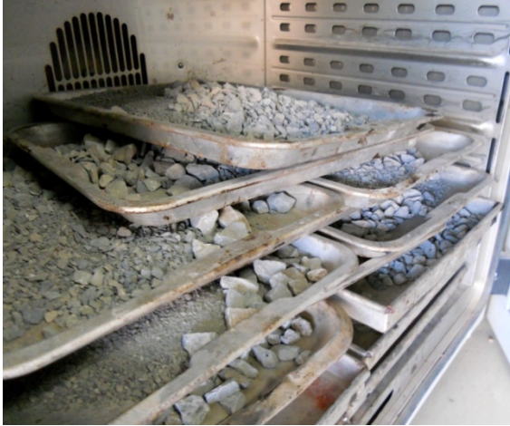
รูปที่ 1.5 ให้ความร้อนมวลรวมที่อุณหภูมิ 163 \pm 8^{\circ}\text{C} และอุ่นแบบบดอัดเตรียมไว้
