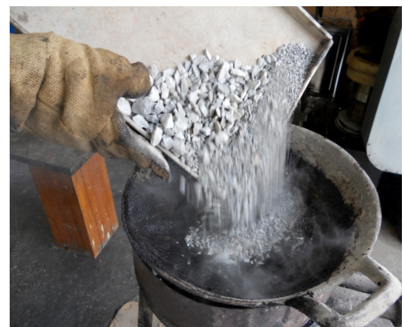
รูปที่ 1.6 ให้ความร้อนแอสฟัลต์ซีเมนต์ที่ 159^{\circ}\text{C} \pm 8^{\circ}\text{C} แล้วนำมาผสมกับมวลรวมร้อนเพื่อเตรียมก้อนตัวอย่าง
