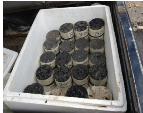
รูปที่ 6.7 การเจาะเก็บก้อนตัวอย่างหลังจากปูและบดอัดแล้วเสร็จ
