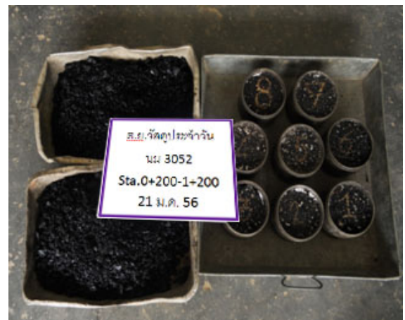
รูปที่ 6.3 การเตรียมก้อนตัวอย่างโดยเก็บวัสดุจากรถบรรทุกก่อนนำไปสถานที่ก่อสร้าง
