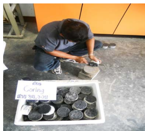
รูปที่ 6.8 การตรวจวัดความหนาก้อนตัวอย่าง และการปรับแต่งผิวหน้าหนาก้อนตัวอย่าง
