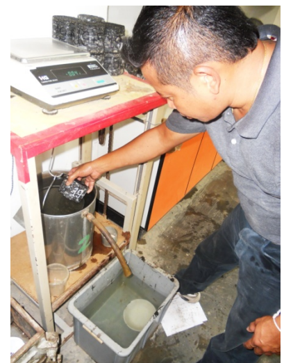
รูปที่ 6.4 ก้อนตัวอย่างที่เก็บจากสนามนำไปทดสอบหาค่าความแน่นเพื่อหาค่าควบคุมการบดทับในสนาม
