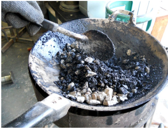
รูปที่ 1.7 คลุกเคล้าส่วนผสมร้อนให้เข้ากันโดยควบคุมอุณหภูมิให้อยู่ระหว่าง 121-163 °C ใช้เวลาประมาณ 1 นาที นำไปบดอัดในแบบเตรียมก้อนตัวอย่างตามวิธีมาร์แชลล์
