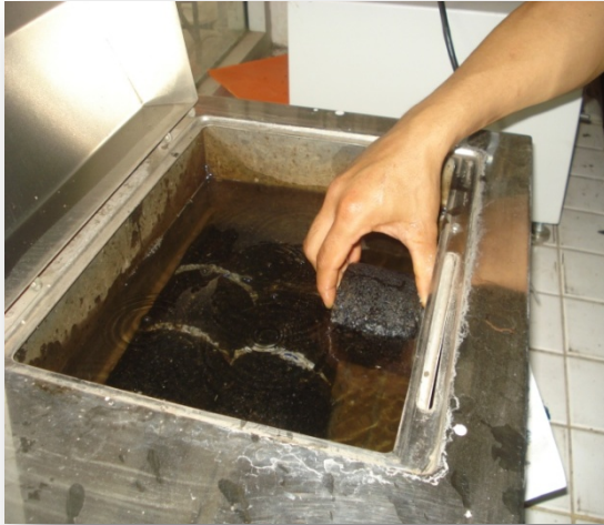
รูปที่ 1.14 อุณหภูมิอย่างในน้ำที่อุณหภูมิ 60^{\circ}\text{C} นาน 30 นาที นำขึ้นมาเช็ดให้แห้ง
