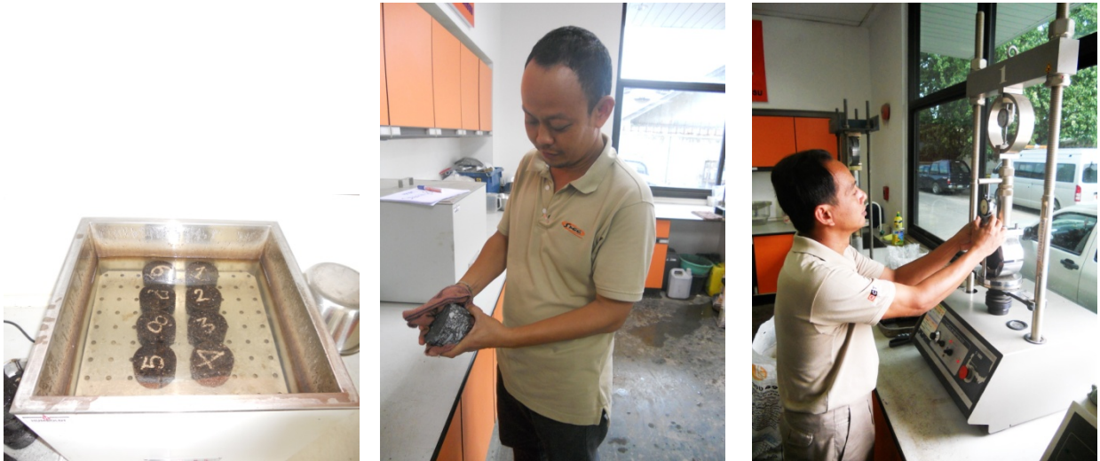
รูปที่ 6.5 การทดสอบหาค่า Marshall Stability และ ค่า Flow ของก้อนตัวอย่างที่เตรียมจากสนาม
