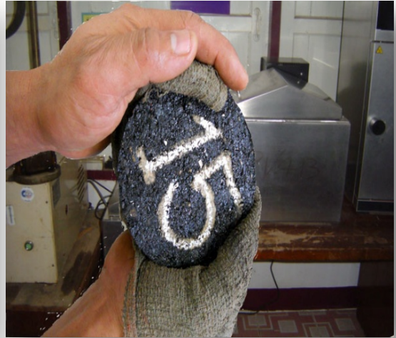
รูปที่ 1.14 อุณหภูมิอย่างในน้ำที่อุณหภูมิ 60^{\circ}\text{C} นาน 30 นาที นำขึ้นมาเช็ดให้แห้ง
