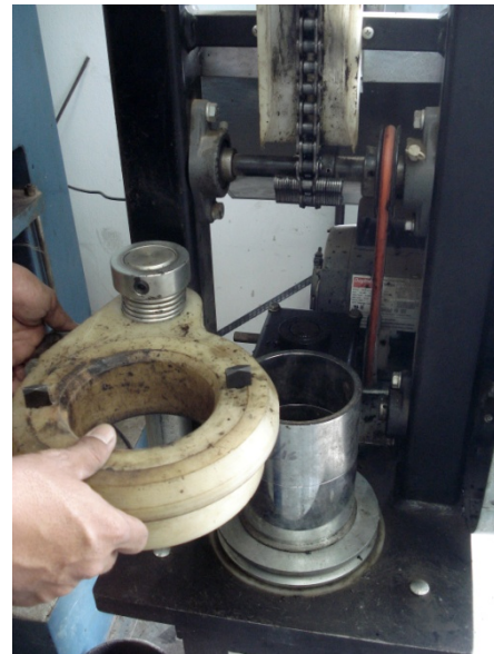
รูปที่ 1.8 นำแบบและสื่อนบดอัดที่อุ่นไว้แล้วมาประกอบเข้ากับแท่นบดอัดตัวอย่าง
