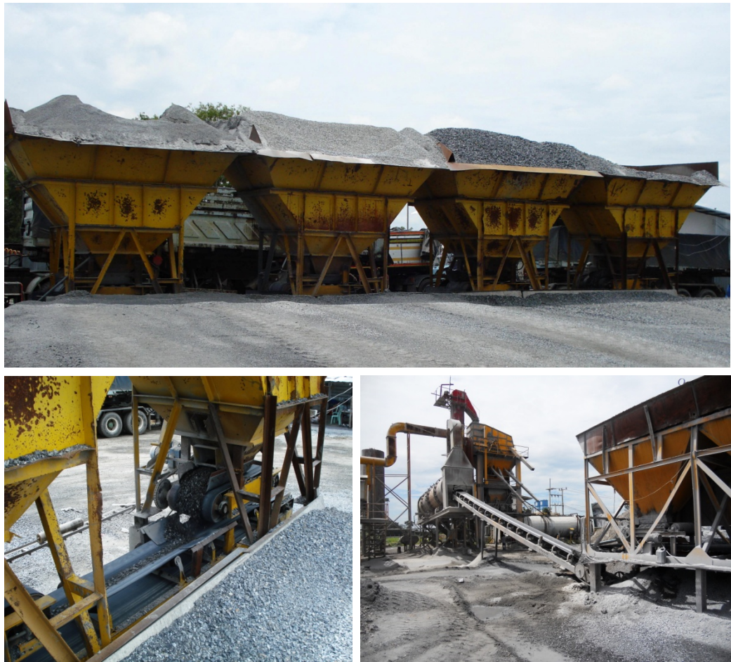
รูปที่ 2.4 ยุ้งหินเย็น (Cold Bin) และ การลำเลียงหินเย็นไปยังหม้อเผา(Dryer)
