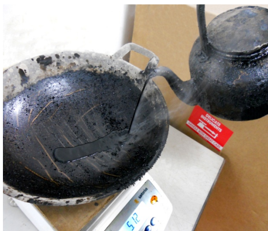
รูปที่ 1.6 ให้ความร้อนแอสฟัลต์ซีเมนต์ที่ 159^{\circ}\text{C} \pm 8^{\circ}\text{C} แล้วนำมาผสมกับมวลรวมร้อนเพื่อเตรียมก้อนตัวอย่าง
