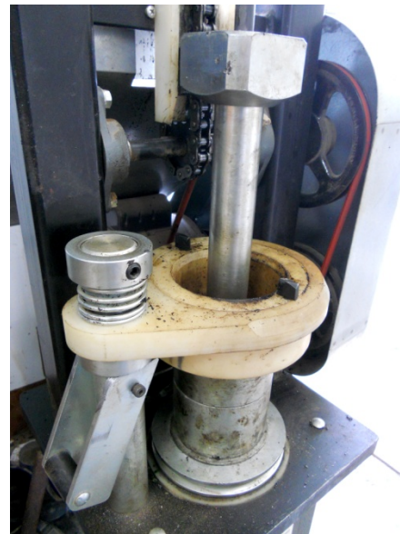
รูปที่ 1.10 รอกอุณหภูมิลดลงที่ 140 \pm 5^{\circ}\text{C} บดอัดตัวอย่างในแบบทั้ง 2 ด้าน โดยปล่อยน้ำหนักมาตรฐานด้านละ 75 ครั้ง
