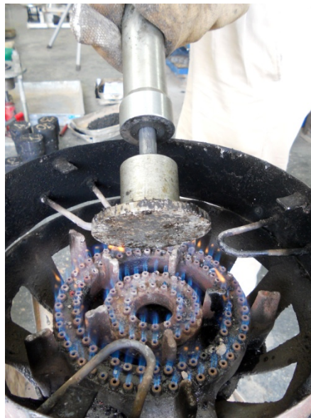
รูปที่ 1.8 นำแบบและสื่อนบดอัดที่อุ่นไว้แล้วมาประกอบเข้ากับแท่นบดอัดตัวอย่าง
