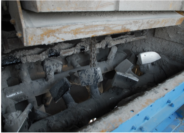
รูปที่ 2.19 ตรวจสอบช่องว่างระหว่างใบพายและหม้อผสม
