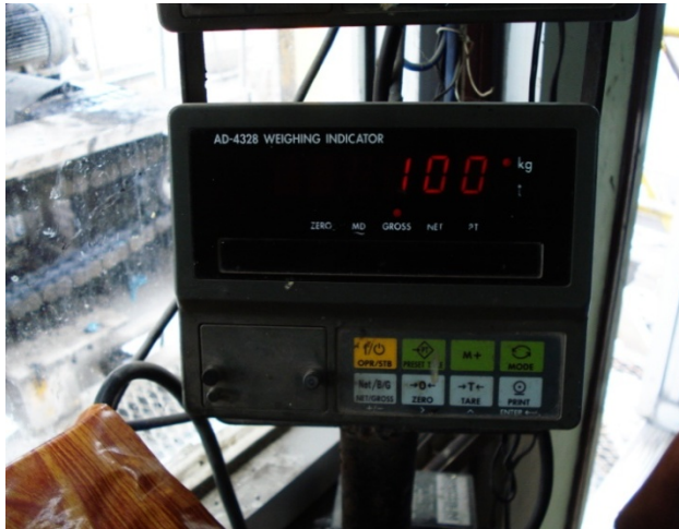
รูปที่ 2.15 ค่าน้ำหนักที่อ่านได้จากหน้าปัดเครื่องชั่ง
