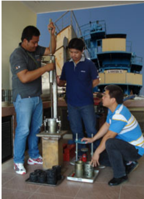
รูปที่ 6.3 การเตรียมก้อนตัวอย่างโดยเก็บวัสดุจากรถบรรทุกก่อนนำไปสถานที่ก่อสร้าง
