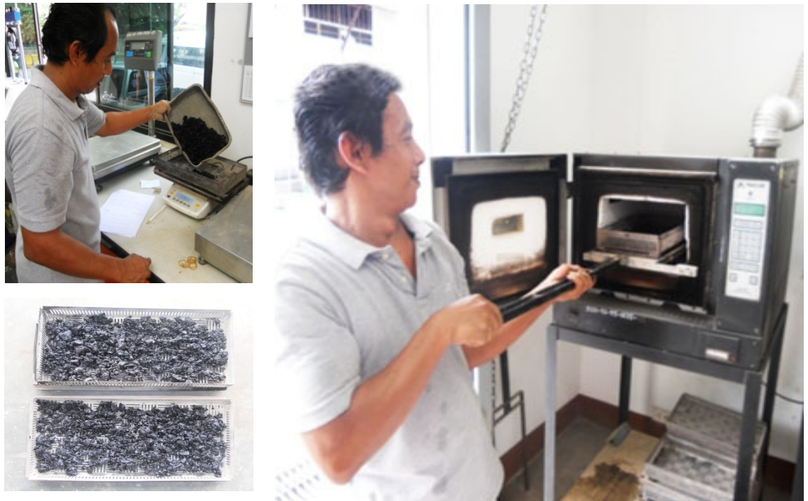
รูปที่ 6.9 นำก้อนตัวอย่างมาย่อยให้แตกออกจากกัน ชั่งน้ำหนัก แล้วนำเข้าเครื่องเผาแยกส่วนผสม (Ignition Oven) เพื่อตรวจสอบปริมาณแอสฟัลต์บรรจุ
