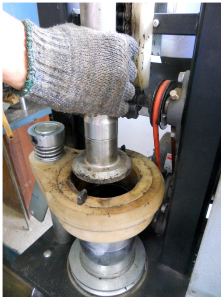
รูปที่ 1.10 รอกอุณหภูมิลดลงที่ 140 \pm 5^{\circ}\text{C} บดอัดตัวอย่างในแบบทั้ง 2 ด้าน โดยปล่อยน้ำหนักมาตรฐานด้านละ 75 ครั้ง
