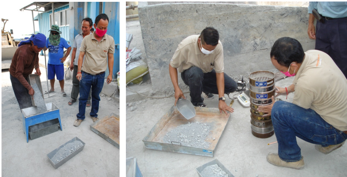
รูปที่ 2.23 นำวัสดุที่ทดลองปล่อยลงหม้อผสมมาตรวจสอบส่วนคละเพื่อเทียบกับสูตรส่วนผสมเฉพาะงานที่ออกแบบไว้
