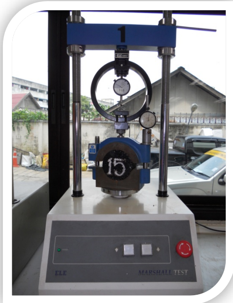
รูปที่ 1.15 ทดสอบหาค่าเสถียรภาพและการไหล
