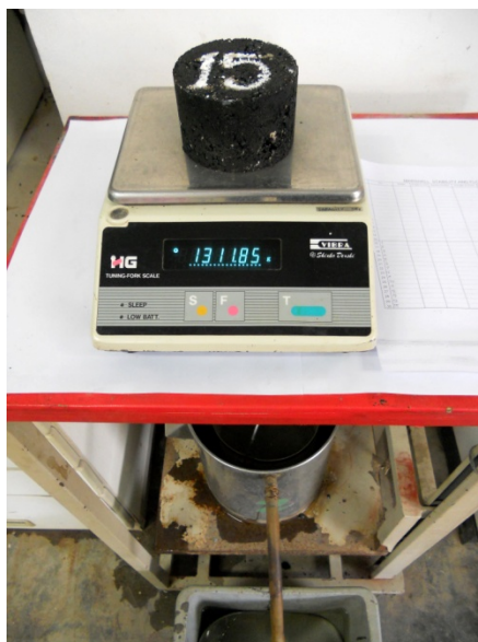
รูปที่ 1.13 ทดสอบหาค่าความถ่วงจำเพาะและความแน่น
