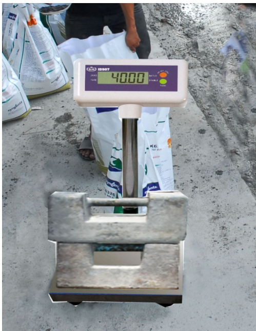
รูปที่ 2.11 การตรวจสอบตุ้มน้ำหนักมาตรฐาน
