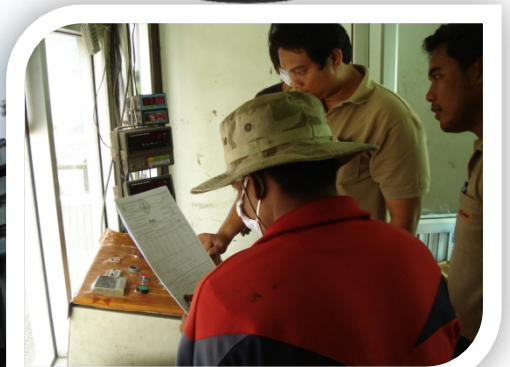
รูปที่ 2.21 การทดลองปล่อยวัสดุตามค่าน้ำหนักที่ปรับเทียบตามกราฟที่ได้จากการตรวจสอบเครื่องชั่ง
