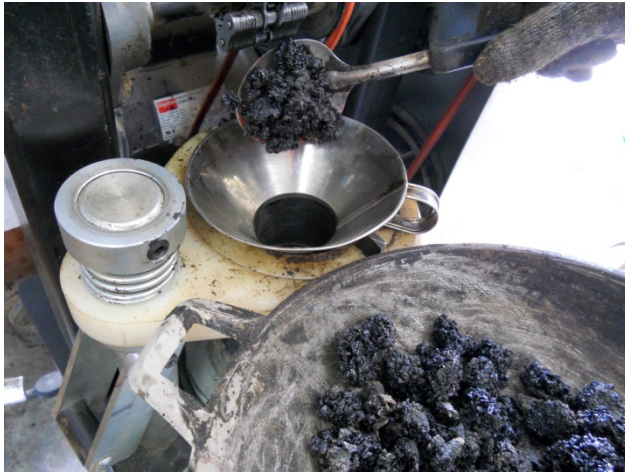
รูปที่ 1.9 นำมวลรวมร้อนและแอสฟัลต์ซีเมนต์ที่ผสมเข้ากันดีแล้ว ใส่ลงในแบบแล้วใช้อุปกรณ์แซะรอบๆด้านในแบบประมาณ 15 ครั้ง และในตัวอย่างอีก 10 ครั้ง
