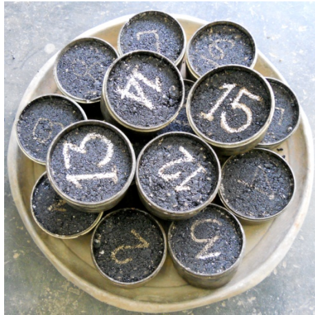
รูปที่ 1.11 พักตัวอย่างไว้ให้เย็นที่อุณหภูมิไม่เกิน 60^{\circ}\text{C} จึงดันตัวอย่างออกจากแบบ
