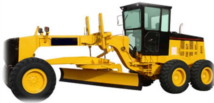
รูปที่ 3.3 รถเกลี่ยปรับระดับ (Motor Grader)
