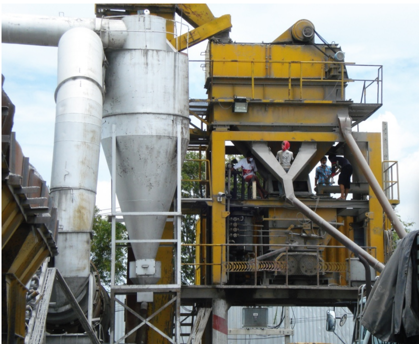
รูปที่ 2.21 การทดลองปล่อยวัสดุตามค่าน้ำหนักที่ปรับเทียบตามกราฟที่ได้จากการตรวจสอบเครื่องชั่ง
