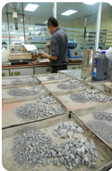
รูปที่ 1.4 การเตรียมตัวอย่างมวลรวม และ แอสฟัลต์ซีเมนต์เพื่อออกแบบสูตรผสม
