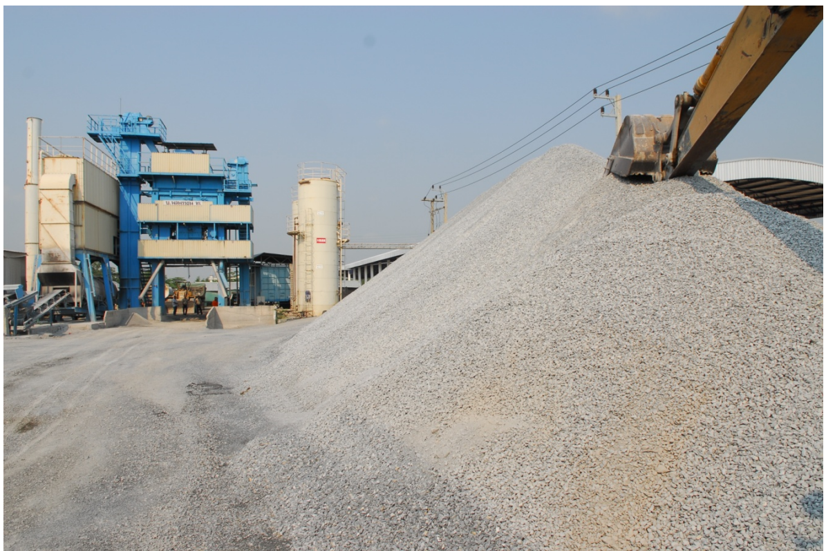
รูปที่ 1.2 สถานที่เก็บกองมวลรวมต้องสะอาดไม่มีน้ำขังหรือเป็นโคลน
