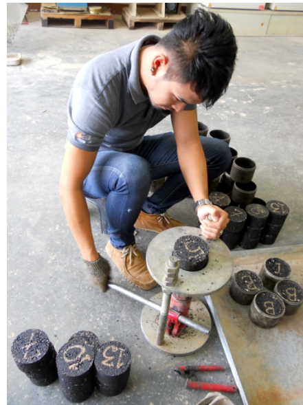
รูปที่ 1.11 พักตัวอย่างไว้ให้เย็นที่อุณหภูมิไม่เกิน 60^{\circ}\text{C} จึงดันตัวอย่างออกจากแบบ
