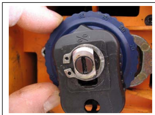
รูปที่ 31 การปรับอัตราการจ่ายสารละลายคลอรีนที่ประมาณ 80%
