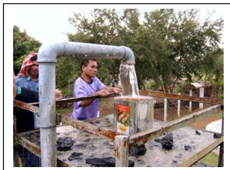
รูปที่ 18 การวัดปริมาณน้ำดิบเข้าสู่ระบบผลิตน้ำ โดยวิธีตวงจับเวลา
