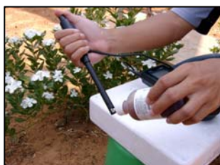
รูปที่ 70 ขั้นตอนการใช้ พีเอชมิเตอร์
