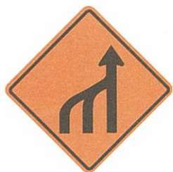
ป้ายเบี่ยงการจราจร(ตก.23)
