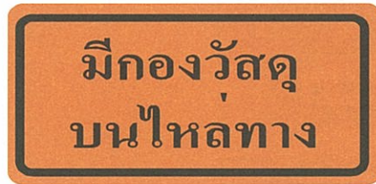
ป้ายเตือนมีกองวัสดุบนไหล่ทาง (ตค.13)
