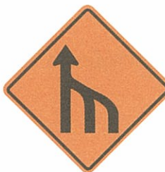
ป้ายเบี่ยงการจราจร(ตก.24)
