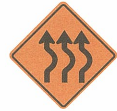
ป้ายเบี่ยงการจราจร (ตก.18)
