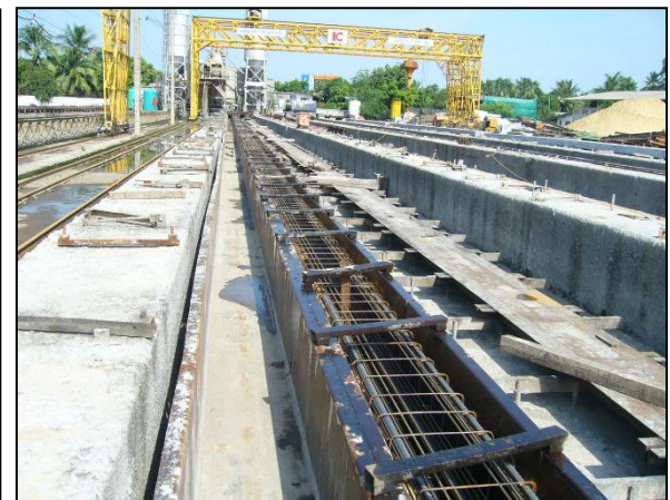
รูปที่ ๕-๑๓ ตรวจสอบเหล็กเสริมและระยะหุ้มคอนกรีตก่อนทำการเทคอนกรีตเสาเข็ม
