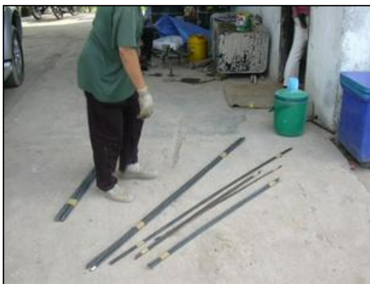
รูปที่ ๔-๗ การเก็บตัวอย่างลวดเหล็กอัดแรงและเหล็กเสริม
