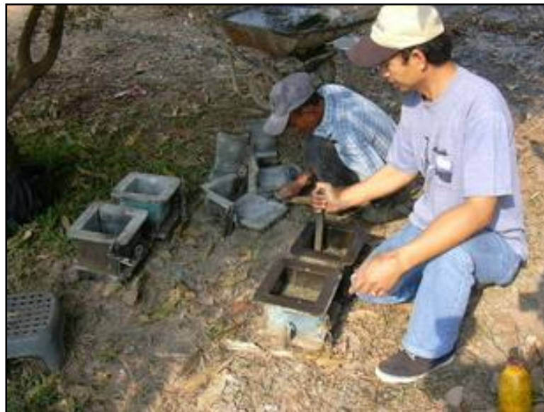
รูปที่ ๔-๙ การเก็บตัวอย่างคอนกรีตรูปลูกบาศก์ ขนาด ๑๕ x ๑๕ x ๑๕ เซนติเมตร
