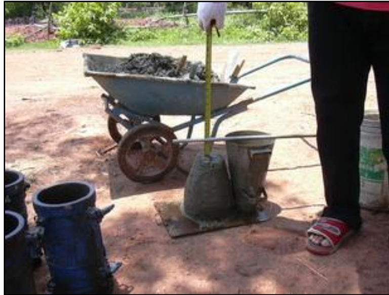
รูปที่ ๔-๘ การทดสอบค่ายุบตัวของคอนกรีต (Slump Test)
