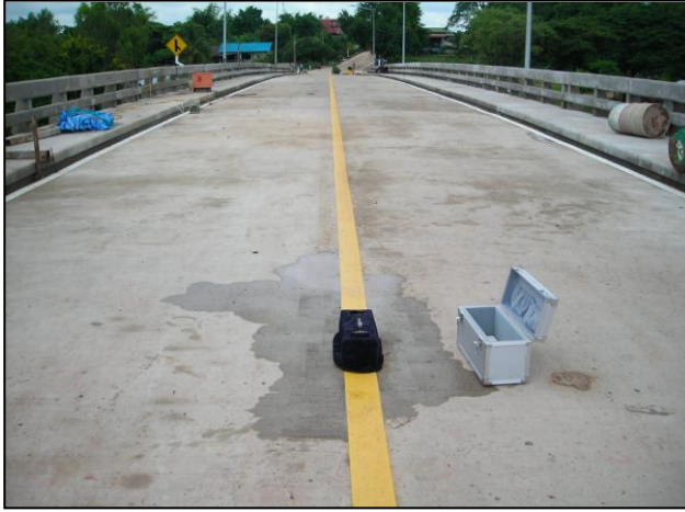
รูปที่ ๗-๒๓ ตรวจสอบค่าการสะท้อนแสงของเส้น จราจร
