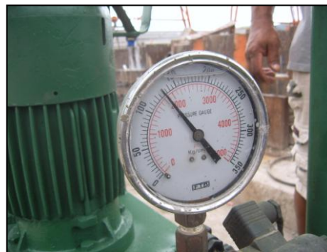
รูปที่ ๖-๑๒ การอ่านค่าแรงดึงลวด
