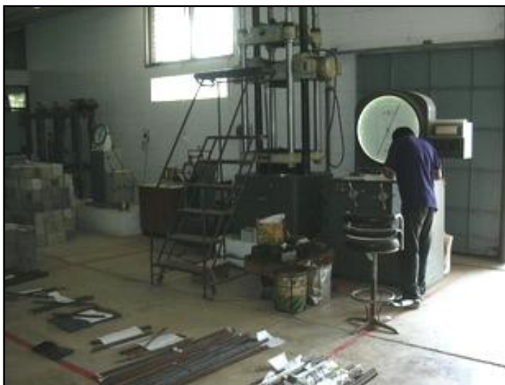
รูปที่ ๔-๖ เครื่องทดสอบความต้านทานแรงดึงวัสดุเหล็กเสริมและลวดอัดแรง
