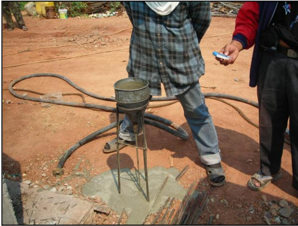
รูปที่ ๖-๔๔ ตรวจสอบความชื้นเหลวของน้ำปูน
