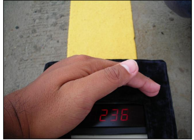
รูปที่ ๗-๒๔ ค่าการสะท้อนแสงที่ปรากฏที่เครื่อง ตรวจสอบ
