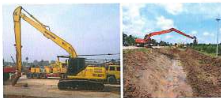
ลักษณะการใช้รถขุดไฮดรอลิกชนิดดินตะขាប់งัดที่ดักเข้าแขนยาว [HB-LR]
