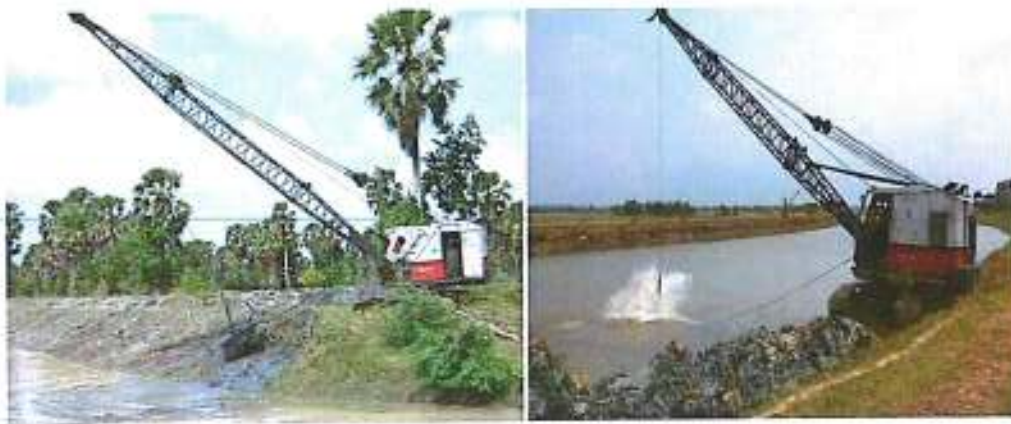
ลักษณะรถขุดชนิดปั้นที่ลาก (Dragline Excavator Crawler Mounted)
