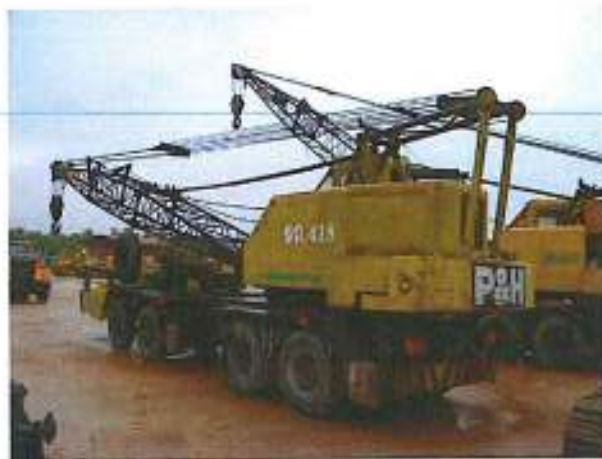
ลักษณะรถขุดปั้นจั่นชนิดล้อยางติดอุปกรณ์ยกและบู้งี่
