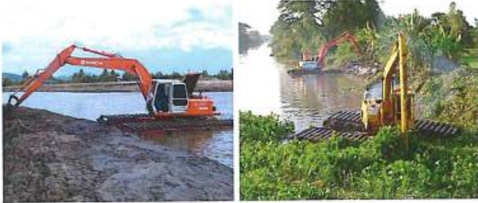
ลักษณะรถขุดไฮดรอลิกชนิดโป๊ะเหล็กบั้งที่ตักเข้า (MB)
