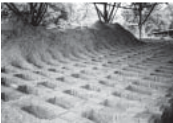
รูปที่ 5-12 การใช้แกลบเป็นเชื้อเพลิงในการเผาอิฐ
