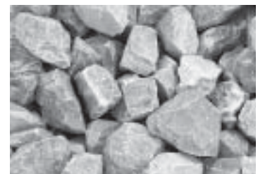
รูปที่ 2-3 ตัวอย่าง Calcareous Materials เช่น หินปูน (Limestone)
