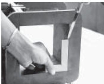
ข) การตรวจสอบมุมฉากของแบบหล่อรูปทรงลูกบาศก์
