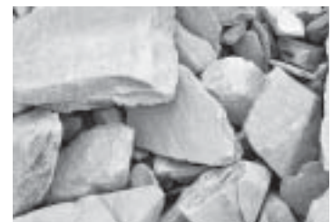
รูปที่ 2-4 ตัวอย่าง Argillaceous Materials เช่น หินดินดาน (Shale)
