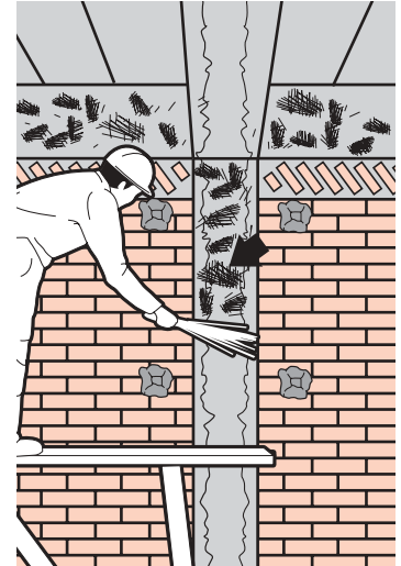
รูปที่ 7-12 การสลัดดอกที่ผิวเสาและ คานคอนกรีต ก่อนทำการฉาบปูน
