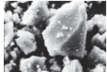
รูปที่ 11-14 ภาพถ่ายกำลังขยายสูงของอนุภาค GGBS
