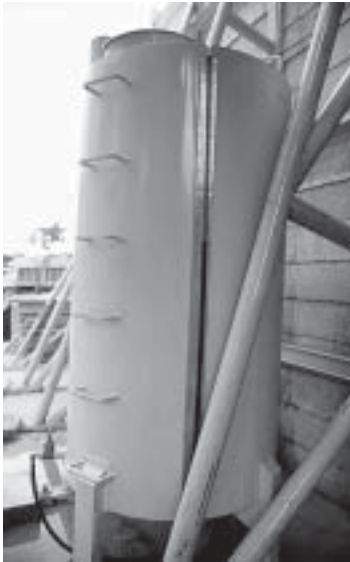
รูปที่ 11-4 การเก็บรักษาสารเคมีผสมเพิ่มไว้ในถังที่ปิดมิดชิด ในโรงงานคอนกรีตผสมเสร็จ
