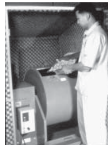
รูปที่ 9-56 เครื่องทดสอบแรงเสียดสี สำหรับการทดสอบความต้านทานการขัดสีของมวลรวม
