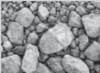
ค) แร่เหล็ก (Iron Ore) ใช้เพิ่ม \text{Fe}_2\text{O}_3
