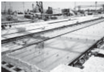
รูปที่ 10-7 การบ่มคอนกรีตด้วยวิธี การขังน้ำ ในโรงงานคอนกรีตสำเร็จรูป
