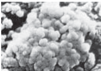
รูปที่ 11-13 ภาพถ่ายกำลังขยายสูงของอนุภาคซิลิกาฟุ้ง
