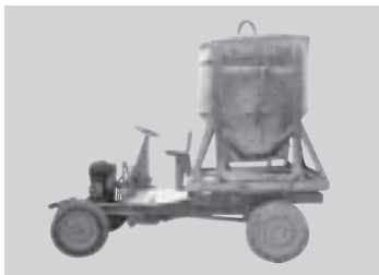
ก) รถบรรทุกถังเหล็กใส่คอนกรีตในโรงงานคอนกรีตสำเร็จรูป
