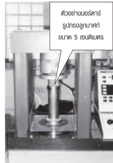
รูปที่ 10-5 การทดสอบกำลังอัดของตัวอย่างมอร์ตาร์
