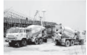
รูปที่ 17-12 รถผสมคอนกรีตมีความจุตั้งแต่ 3 - 5 ลูกบาศก์เมตร
