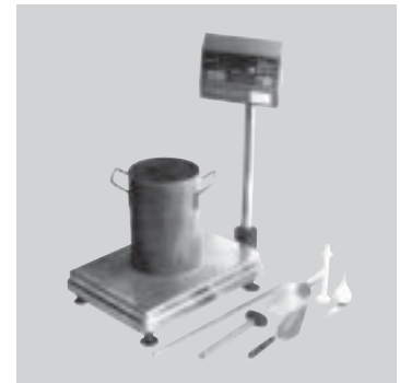
รูปที่ 12-36 อุปกรณ์ทดสอบการซึม
