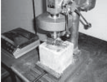
รูปที่ 16-5 การทดสอบความต้านทานการขัดสี (Abrasion Resistance) ตามมาตรฐาน ASTM C 944
