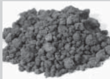
ง) ดินลูกรัง (Laterite) ใช้เพิ่ม \text{Fe}_2\text{O}_3
