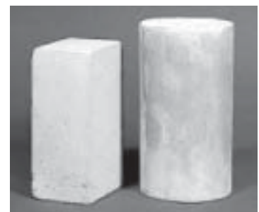
รูปที่ 1-7 หินของเกาะปอร์ตแลนด์ (ซึ่งเป็นที่มาของชื่อปูนซีเมนต์ปอร์ตแลนด์) และตัวอย่างคอนกรีตรูปทรงกระบอก 8
