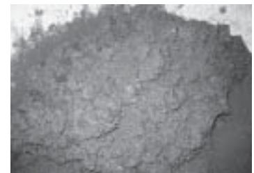
รูปที่ 13-4 ลักษณะเนื้อคอนกรีตสดที่ใช้ส่วนผสมโดยปริมาตร สูตร 1 : 1.5 : 2
