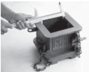
ก) การวัดขนาดของแบบหล่อรูปทรงลูกบาศก์
