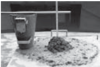
รูปที่ 12-9 คอนกรีตเกิดการแยกตัว เนื่องจากการออกแบบส่วนผสมคอนกรีตไม่เหมาะสม
