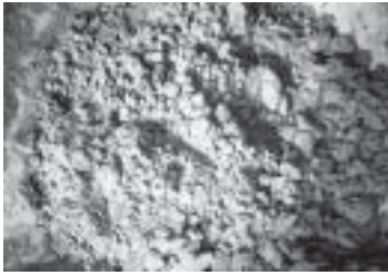
รูปที่ 11-18 คอนกรีตที่มีความสามารถ เทได้ต่ำมาก จะก่อให้เกิดฟองอากาศได้ ยากมาก
