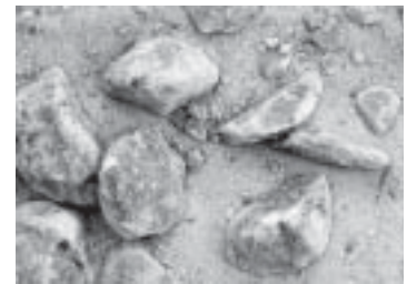
รูปที่ 2-7 ตัวอย่าง Additive Materials เช่น ยิปซั่ม (Gypsum)
