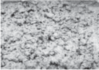
รูปที่ 8-2 คอนกรีตสดที่ดี ควรมีความชื้นเพียงพอเหมาะกับการใช้งานมีเนื้อสม่ำเสมอ และไม่แยกตัว
