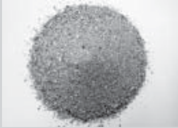
ก) ทราย (Sand) ใช้เพิ่ม \text{SiO}_2
