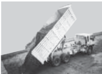
ข) รถบรรทุกเทท้ายใช้ในการล่ำเลียงและการเทคอนกรีตงานเขื่อน และงานพื้นสนามบิน
