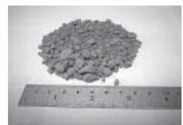
รูปที่ 7-5 ลักษณะปูนซีเมนต์จับตัวเป็นก้อน ซึ่งเกิดจากวิธีการกองเก็บปูนซีเมนต์ที่ไม่ถูกวิธี
