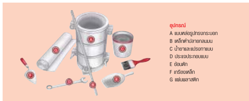
รูปที่ 15-14 อุปกรณ์ทำตัวอย่างคอนกรีตรูปทรงกระบอก
