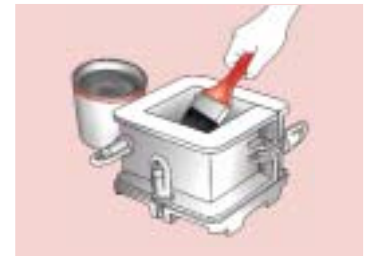
ก) ทำความสะอาดแบบหล่อ และทาสีทาแบบให้ทั่ว
