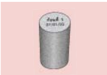
จ) ถอดแบบออก เขียนรายละเอียดของก้อนปูน แล้วนำไปบ่มในน้ำ
