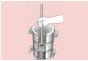
ข) ตักคอนกรีตใส่แบบ 3 ชั้น ให้มีปริมาตรแต่ละชั้นเท่า ๆ กันแต่ละชั้นตัก 25 ครั้ง
