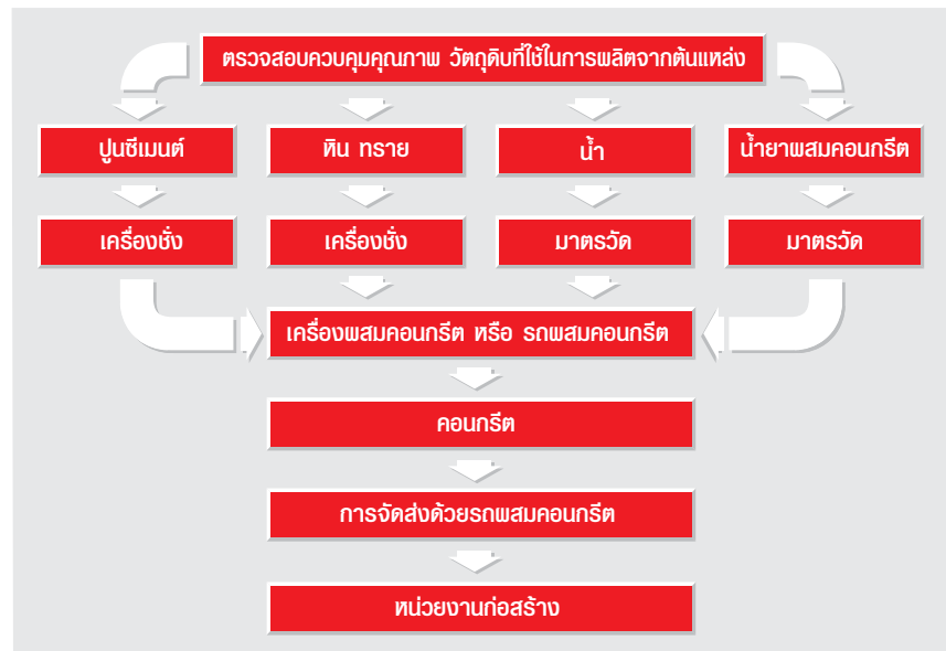
รูปที่ 17-9 กระบวนการผลิตคอนกรีตผสมเสร็จ
