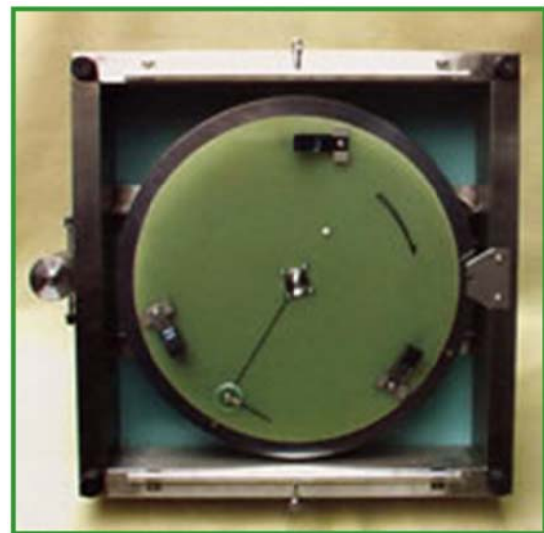
รูปที่ 2 Dynamic Friction Tester (DFT)
