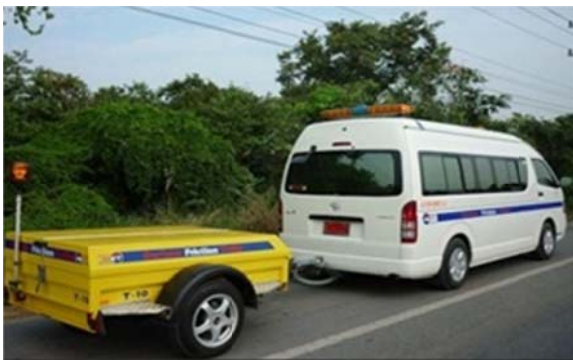
รูปที่ 13 เครื่องมือที่ใช้ในการเก็บข้อมูลความฝืด Skid ASFT-10
