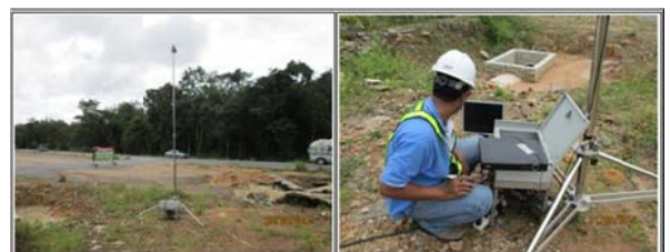
รูปที่ 15 เครื่องมือและการสำรวจปริมาณจราจรด้วยเครื่องมือ Microwave Radar
