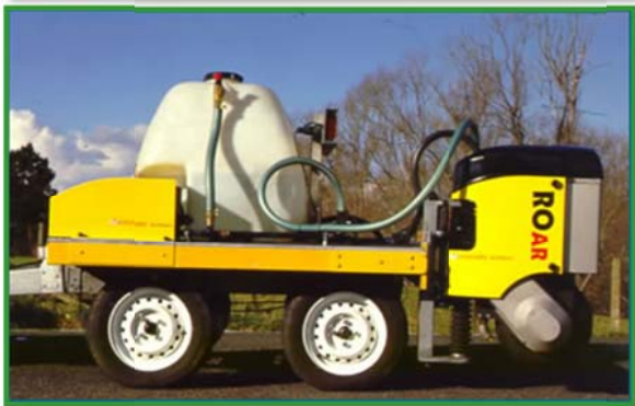
รูปที่ 4 รถทดสอบความฝืดแบบ Fixed Slip และ Variable Slip ตามลำดับ
