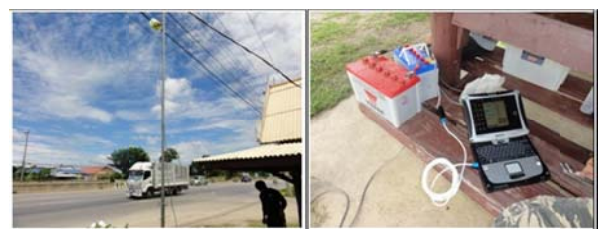
รูปที่ 16 เครื่องมือและการสำรวจปริมาณจราจรด้วยเครื่องมือ Microwave Radar
