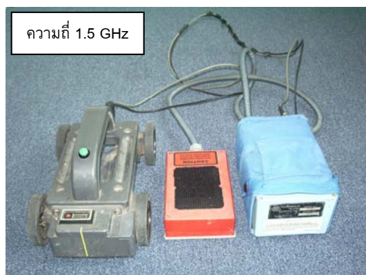
รูปที่ 2.2.2-3 อุปกรณ์หัวส่งและรับสัญญาณ (Transmitting and Receiving Antenna)
