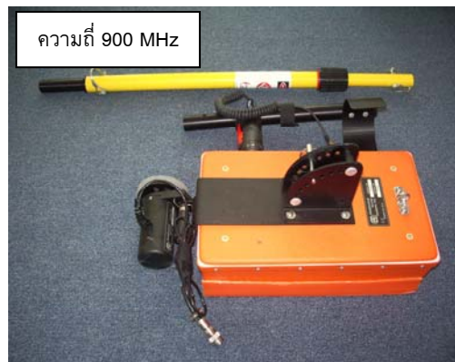
รูปที่ 2.2.2-3 อุปกรณ์หัวส่งและรับสัญญาณ (Transmitting and Receiving Antenna)
