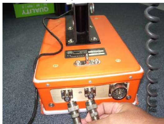
รูปที่ 2.2.2-7 ขั้นตอนการเชื่อมต่อระบบของเครื่องมือ GSSI SIR-20 (ต่อ)
