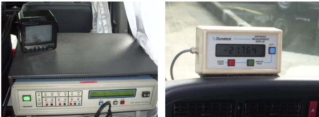
รูปที่ 2.3.1-5 กล้องและจอแสดงภาพและเครื่องวัดระยะทางอัตโนมัติ
