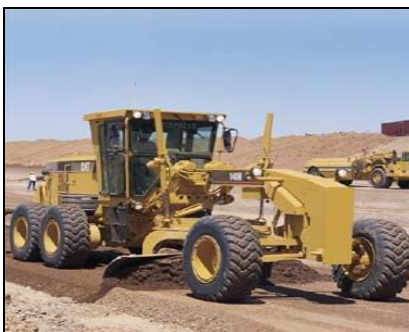
รถเกลี่ยปรับระดับ (Motor Grader) สำหรับเกลี่ยปรับระดับวัสดุ Premix
