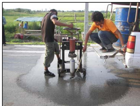
เครื่องเจาะก้นตัวอย่าง (Core - drilling Machine) ในสนาม
