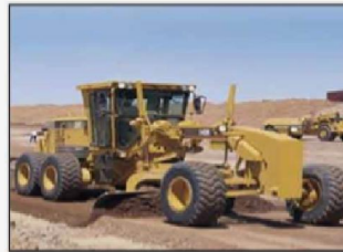
รถเกลี่ยปรับระดับ (Motor Grader) สำหรับเกลี่ยปรับระดับวัสดุ Premix
