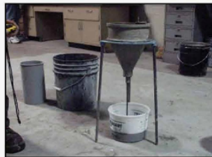
เครื่องมือทดสอบการไหล (แบบ Flow Cone) ใช้สำหรับทดสอบคุณสมบัติของคอนกรีต เพื่อ ใช้ในงาน Subsealing
