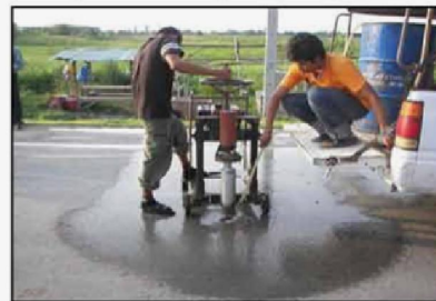
เครื่องเจาะก้นตัวอย่าง (Core - drilling Machine) ในสนาม
