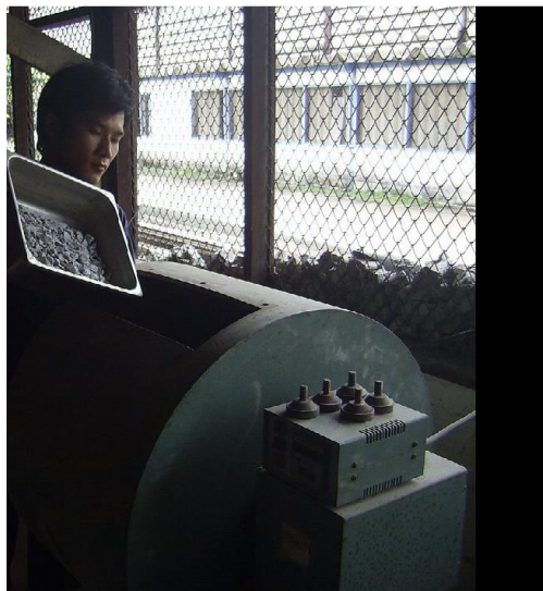
รูปที่ ๔ ใส่ตัวอย่างและลูกเหล็กลงในเครื่องทดสอบรูปที่ ๑ เครื่องครบตามจำนวนรอบที่กำหนด
