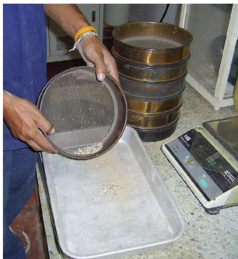
รูปที่ ๑.๓ แยกตัวอย่างที่ค้างบนแต่ละตะแกรง ตะแกรง ออกจากตะแกรงแต่ละขนาด
