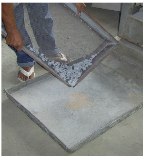
รูปที่ ๒.๓ แยกตัวอย่างที่ค้างแต่ละตะแกรงรูปที่ ออกจากตะแกรงแต่ละขนาด
