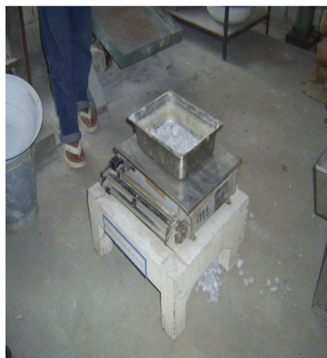
๒.๔ ชั่งน้ำหนักตัวอย่างที่ค้างตะแกรง
