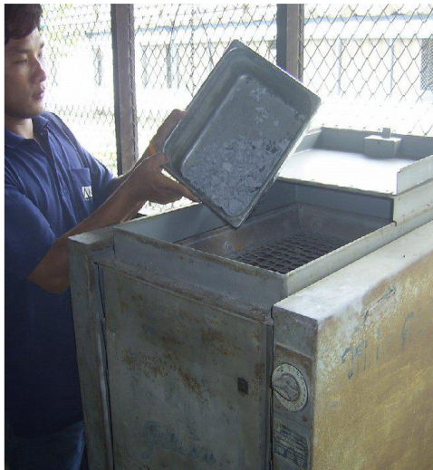
รูป ๒.๑ ติดตั้งตะแกรงกับเครื่องรูปที่ ใส่ตัวอย่างที่เตรียมไว้ลงไป
