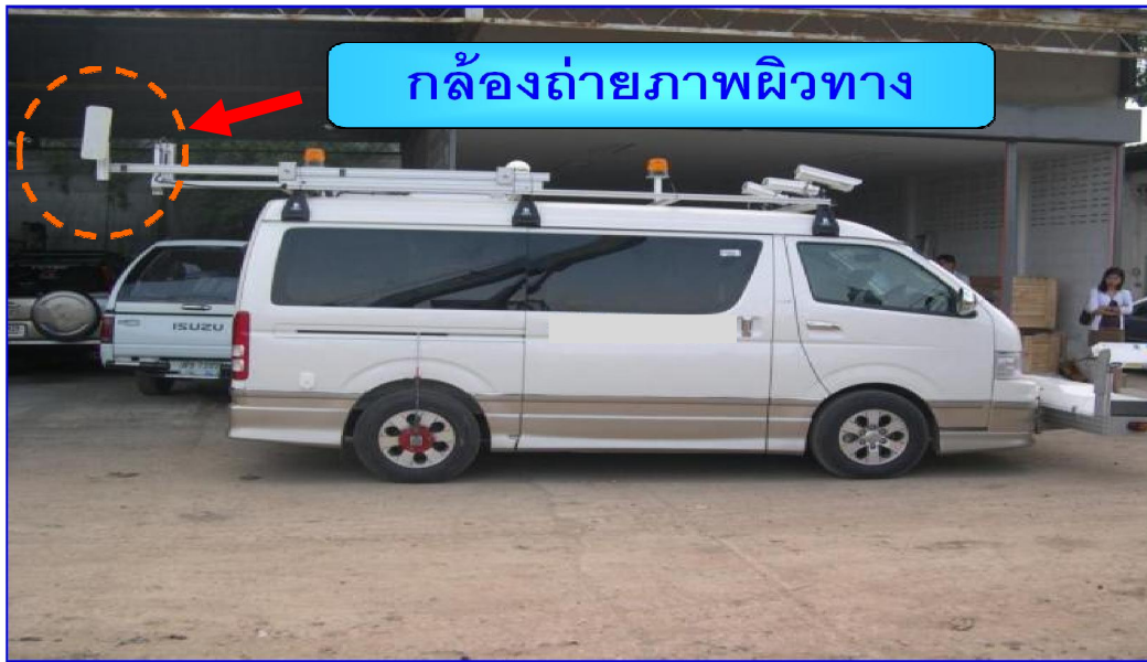
รูปที่ ง.6 ลักษณะการติดตั้งกล้องถ่ายภาพผิวทาง
