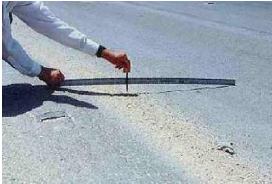
รูปที่ 14 ความเสียหายประเภทร่องล้อ
