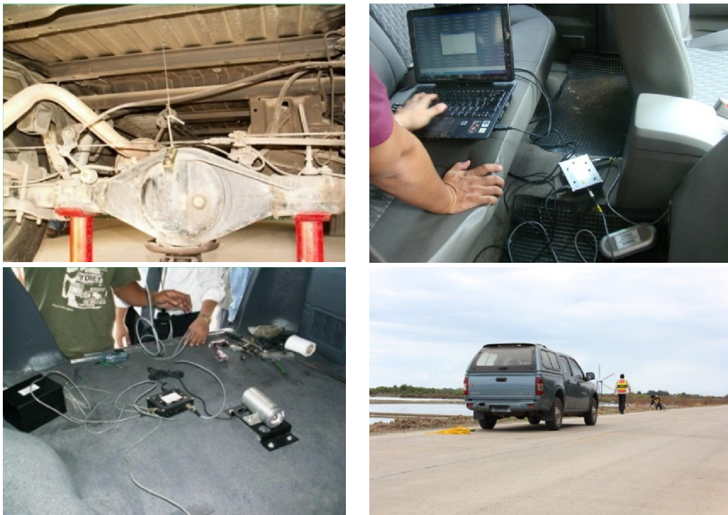
รูปที่ 3 การติดตั้งอุปกรณ์ Bump Integrator ในรถสำรวจ
