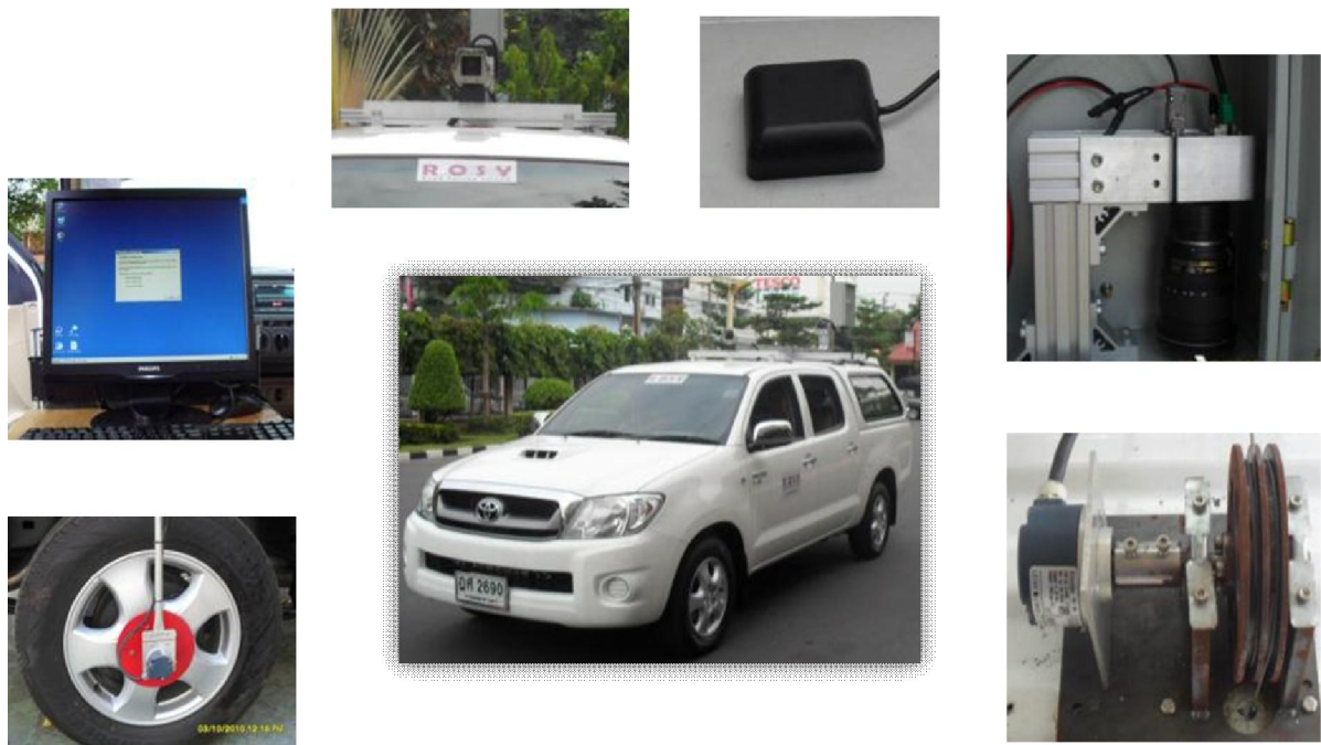
รูปที่ ง.2 องค์ประกอบในรถสำรวจสภาพทาง ROSY
