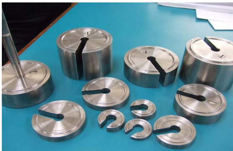
ภาพที่ 6 ภาพค้อนน้ำหนักแบบมาตรา เครื่องมือตรวจสอบชั่งตวงวัดในการทดสอบน้ำหนักเครื่องชั่ง
