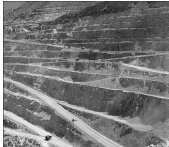
รูปที่ 5 การผลิตจากยอดเขา (Top Down Quarry)
