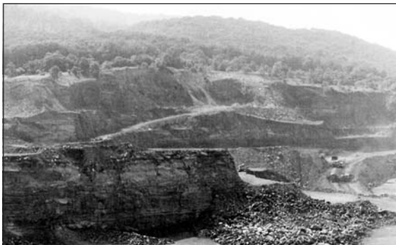
รูปที่ 4 การผลิตจากข้างเขา (Side Hill Quarry)
