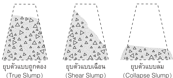
รูปที่ 5 รูปแบบการยุบตัว
