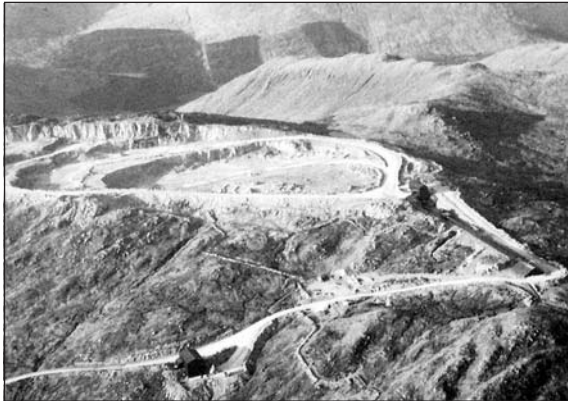
รูปที่ 7 การผลิตจากบ่อนยอตเขา (Semi Open Pit Quarry)
