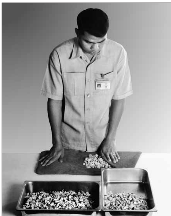
รูปที่ 8 การเช็ดหินให้อยู่ในสภาพอิ่มตัว
