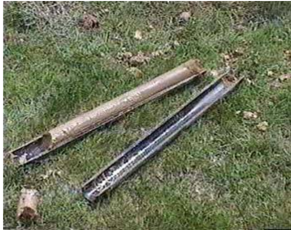
รูปที่ 2.12 แสดงกระบอกเก็บตัวอย่างแบบกระบอกผ่า
