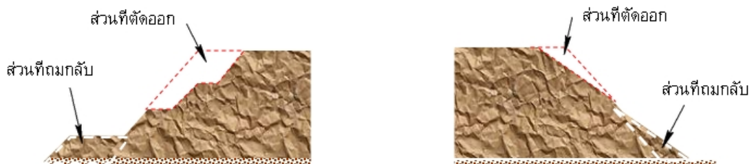
รูปที่ 5.21 แสดงการตัดส่วนบนแล้วนำมาถมส่วนล่าง
