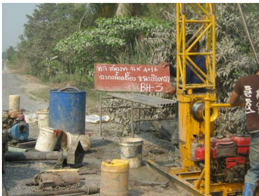
รูปที่ 2.10 แสดงการเจาะสำรวจแบบฉีดล้างด้วยเครื่องโรตารี
