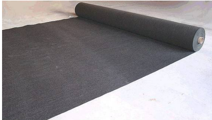
รูปที่ 4.23 แสดงวัสดุสังเคราะห์ประเภท Geotextiles
