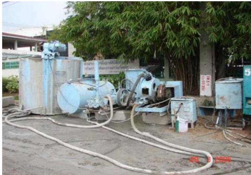
รูปที่ 4.39 เครื่องอัดน้ำปูนเพื่อลำเลียงเข้าไปผสมกับดิน
