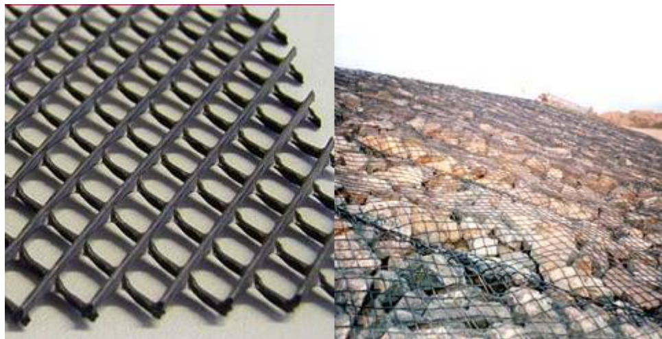
รูปที่ 4.25 แสดงวัสดุสังเคราะห์ประเภท Geonets
