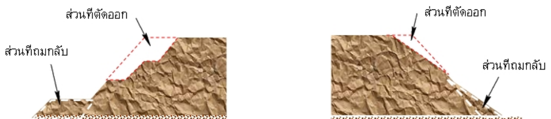
รูปที่ 4.10 แสดงการตัดส่วนบนแล้วนำมาถมส่วนล่าง
