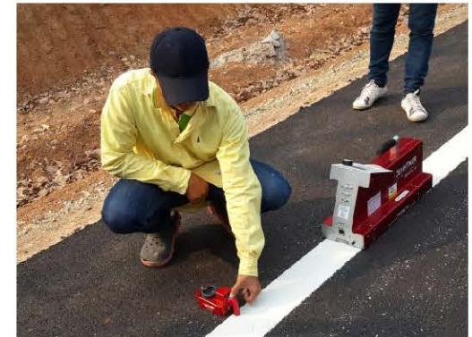
การตรวจสอบคุณลักษณะของงานตีเส้นจราจร
