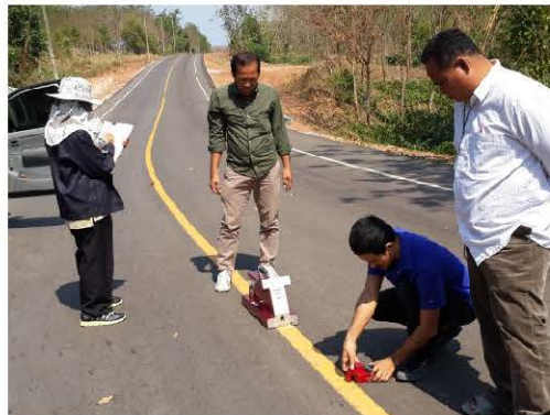
การตรวจสอบคุณลักษณะของงานตีเส้นจราจร
