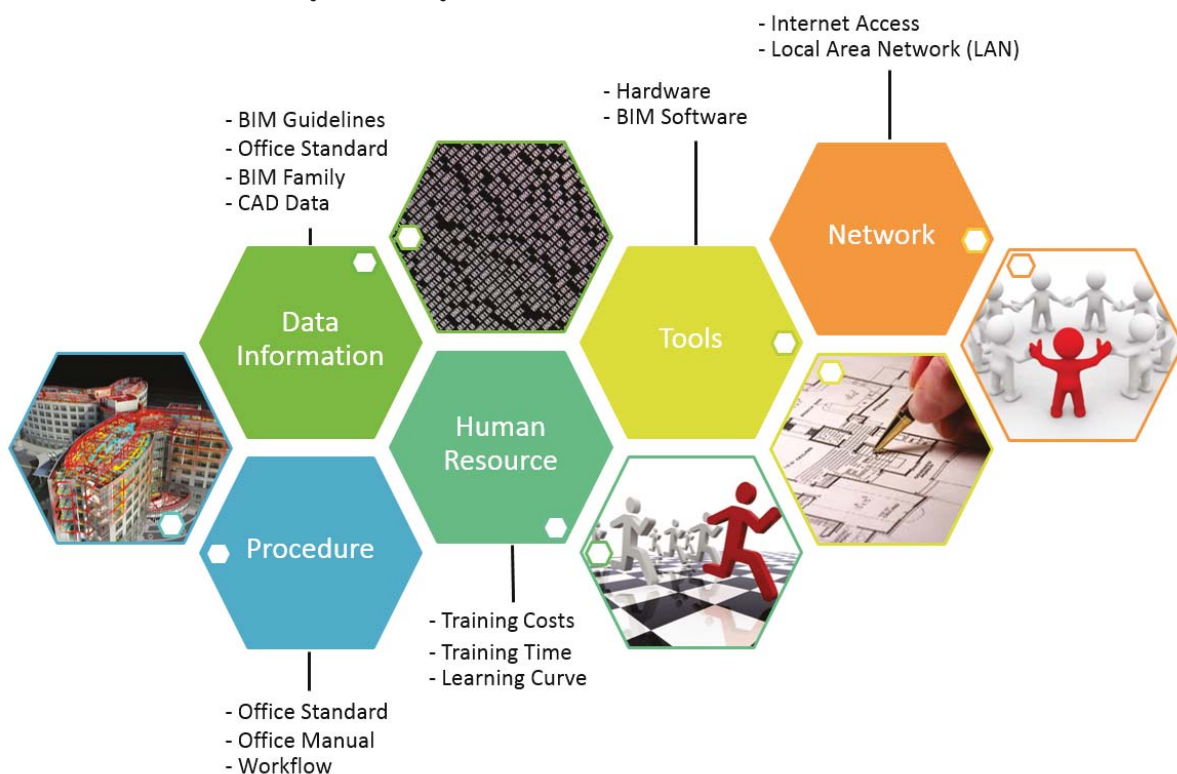
ภาพที่ 2.5 แสดงองค์ประกอบต่างๆ สำหรับการเตรียมความพร้อมองค์กรออกแบบที่ใช้งานระบบ BIM
