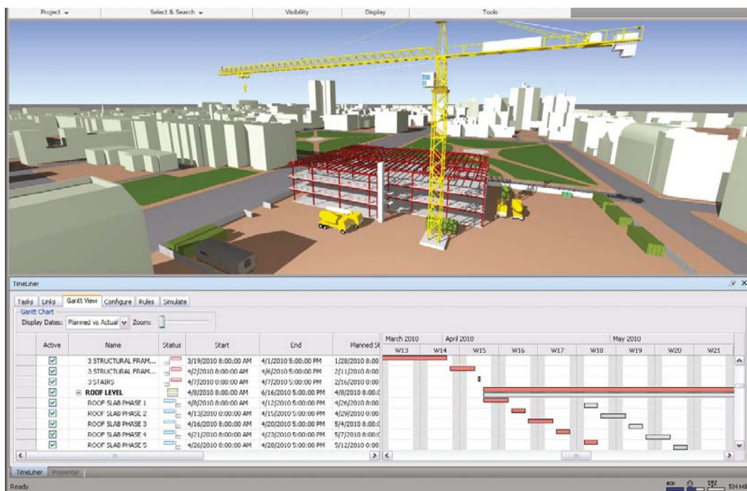
ภาพที่ 1.4 การนำ BIM ไปใช้ในการบริหารงานก่อสร้าง ที่มา: http://www.mrasbuilt.com/MAB_BIM_Navis.html
