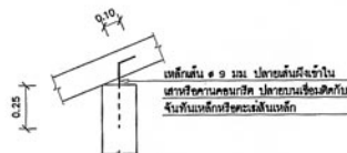
ขยาย ข การตั้งจันทันเหล็กและตะเฒเส้นเหล็กบนเสาหรือคานคอนกรีต
