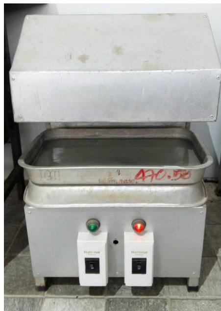
รูปที่ ๑๖ นำตัวอย่างที่ผ่านการล้างมาเป่าลมร้อน
