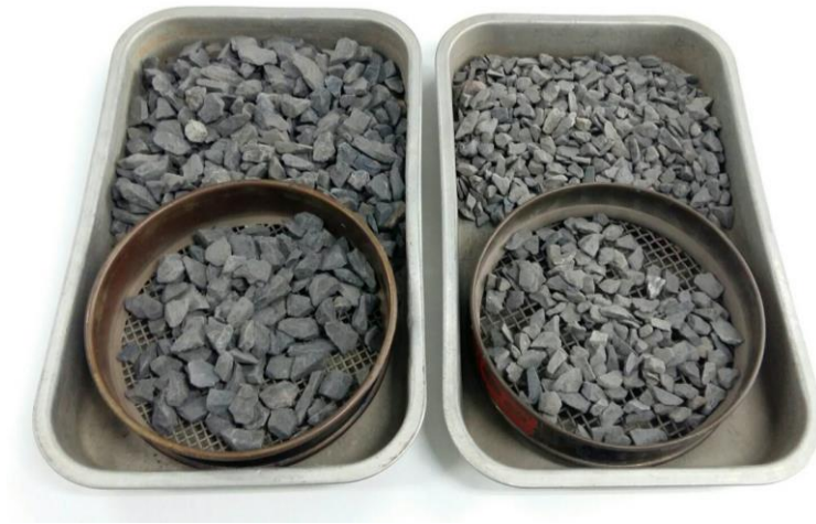
รูปที่ ๔๖ มวลหยาบที่ค้างบนตะแกรงมาตรฐาน
