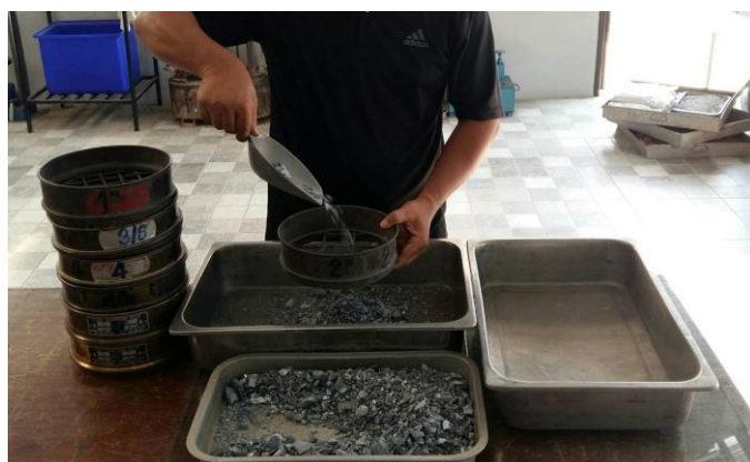
รูปที่ ๑๒ การร่อนตัวอย่างผ่านตะแกรง
