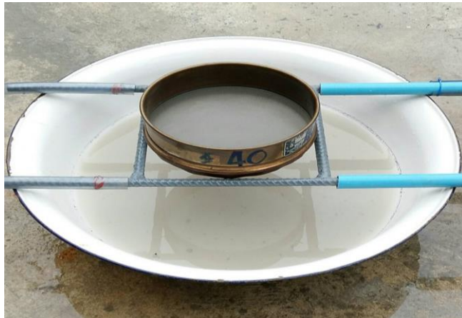
รูปที่ ๑๕ ล้างตัวอย่างผ่านตะแกรงเบอร์ ๔๐
