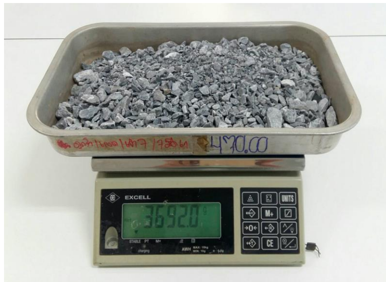
รูปที่ ๕๓ ชั่งน้ำหนักตัวอย่างที่เหลือหลังจากที่อบให้จนแห้ง
