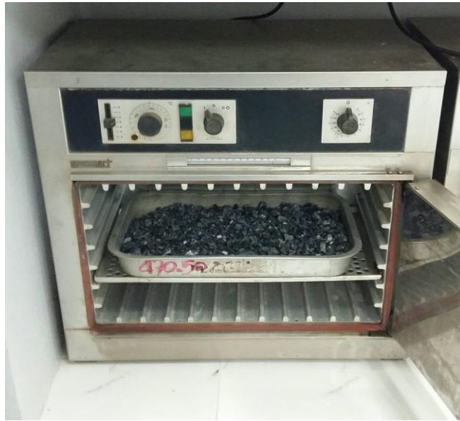
รูปที่ ๕๒ นำตัวอย่างส่วนที่ค้ำตะแกรงเบอร์ ๑๒ ที่ล้างเรียบร้อยแล้วเข้าตู้อบให้แห้ง
