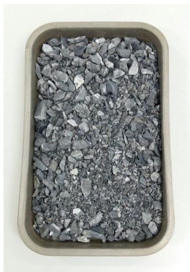
รูปที่ ๑๐ ตัวอย่างส่วนที่ค้ำตะแกรงเบอร์ ๒๐๐ ผ่านการอบ สำหรับการร่อนผ่านตะแกรง
