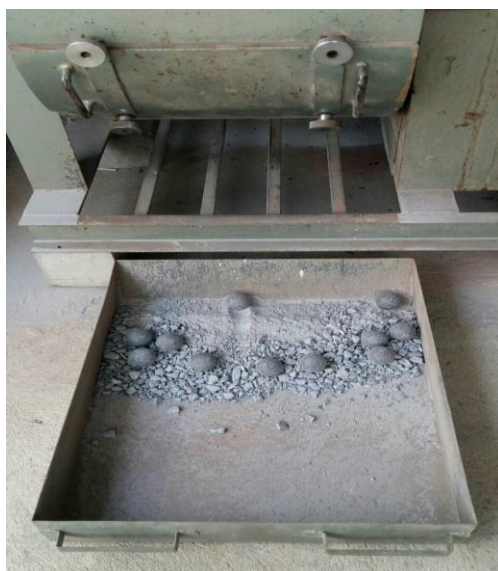
รูปที่ ๔๙ แยกตัวอย่างออกจากลูกเหล็กหลังจากหมุนเครื่องครบตามจำนวนรอบที่กำหนด
