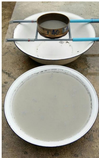
รูปที่ ๑๔ นำตัวอย่างแช่น้ำ
