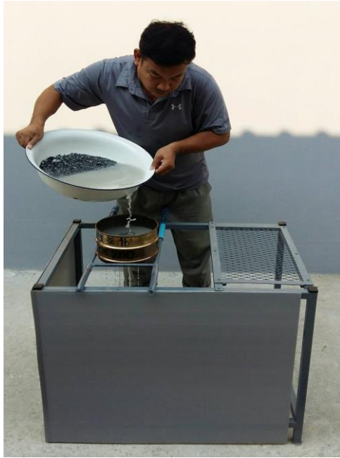
รูปที่ ๗ ทำการล้างตัวอย่างผ่านตะแกรงเบอร์ ๒๐๐ โดยมีตะแกรงเบอร์ ๑๖ วางซ้อนไว้ด้านบน
