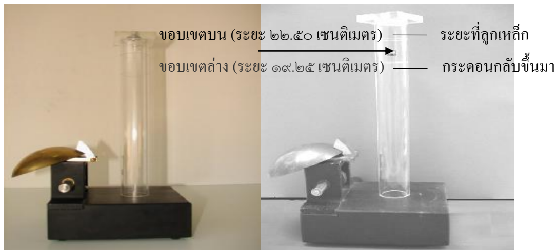
รูปที่ ๓๑ ทดสอบการกระดอนบนแท่นยางของอุปกรณ์ทดสอบ Liquid Limit
