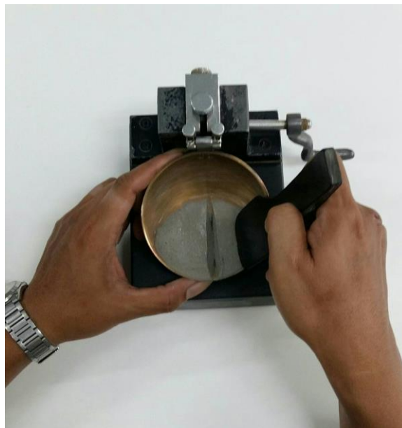
รูปที่ ๒๒ ใช้มีดปาดดินตักตัวอย่างบริเวณที่ตัวอย่างเคลื่อนที่มาสัมผัสกัน
