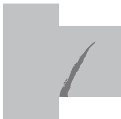
รอยร้าวบริเวณรอยต่อเสา-คาน
