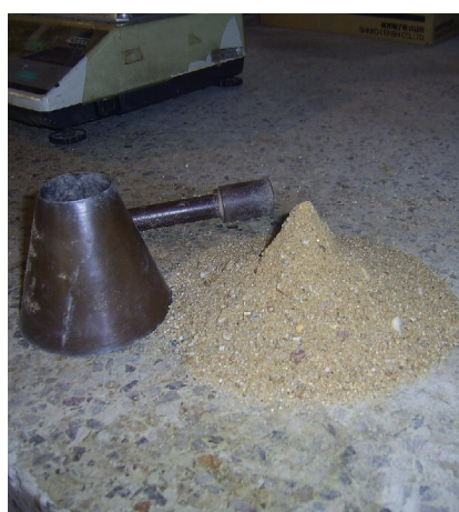
รูปที่ 5 ลักษณะรูปทรงทรายเมื่อมี สภาพอิ่มตัวผิวแห้ง
