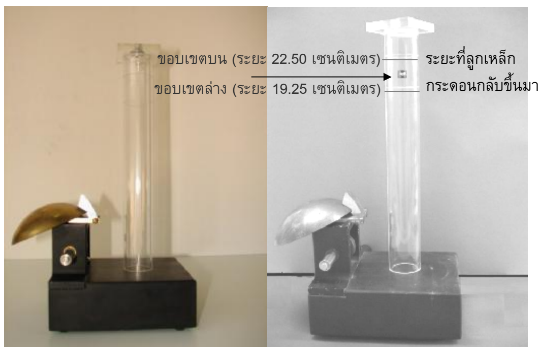
รูปผนวกที่ 1 ทดสอบการกระดอนบนแท่นยางของอุปกรณ์ทดสอบ Liquid Limit
