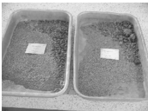
รูปที่ 4 ตัวอย่างส่วนที่ค้างตะแกรงเบอร์ 200 สำหรับการร่อนผ่านตะแกรง
