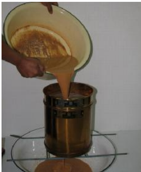
รูปที่ 3 การล้างตัวอย่างผ่านตะแกรงเบอร์ 200 โดยมีตะแกรงเบอร์ 16 วางซ้อนไว้ด้านบน
