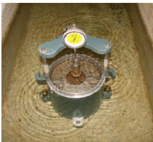
รูปที่ 2 วิธีวัดค่าการบวมตัวของตัวอย่าง ทดสอบแบบแช่น้ำ
