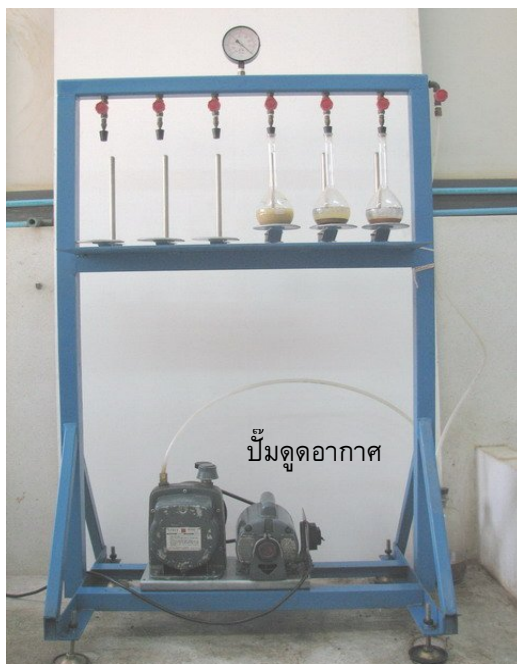
รูปที่ 2 การติดตั้งขวด Pycnometer เข้ากับเครื่องทำสุญญากาศ
