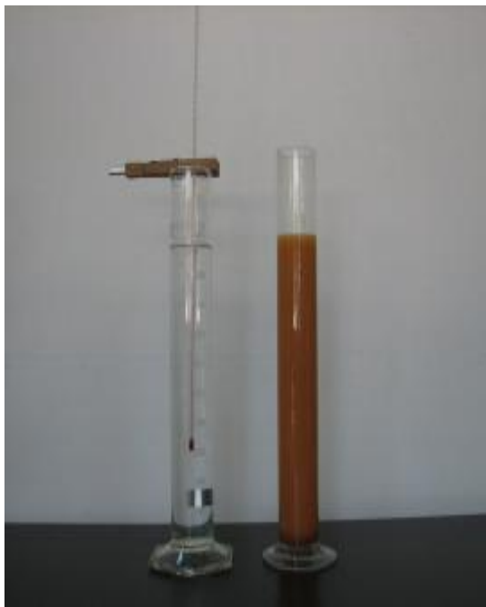
รูปที่ 3 การใช้ไฮโดรมิเตอร์วัดค่าเพื่อหาขนาดเม็ดดิน
