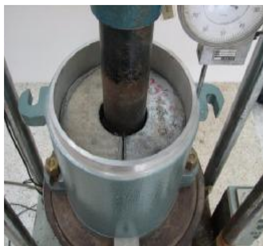
รูปที่ 3 การตั้งให้แท่งกดอยู่ตรงพอดีกับรูตรง กลางของน้ำหนักกดทับ
