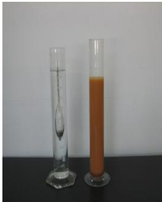
รูปที่ 4 การเก็บไฮโดรมิเตอร์ในขณะรอเวลาทดสอบ
