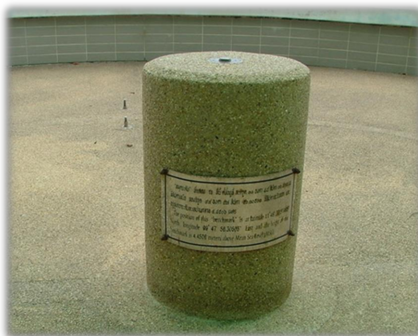
รูป ๑ หมุด BMA ต.เกาะหลัก อ.เมือง จ.ประจวบคีรีขันธ์
