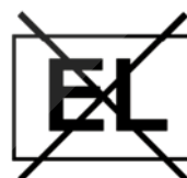
รูปที่ 3 หลอดที่ไม่เหมาะสมกับการทำงานฉุกเฉิน
