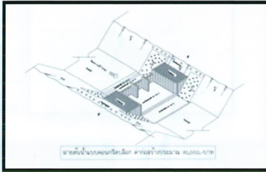
ฝายต้นน้ำแบบคอนกรีตบล็อก
