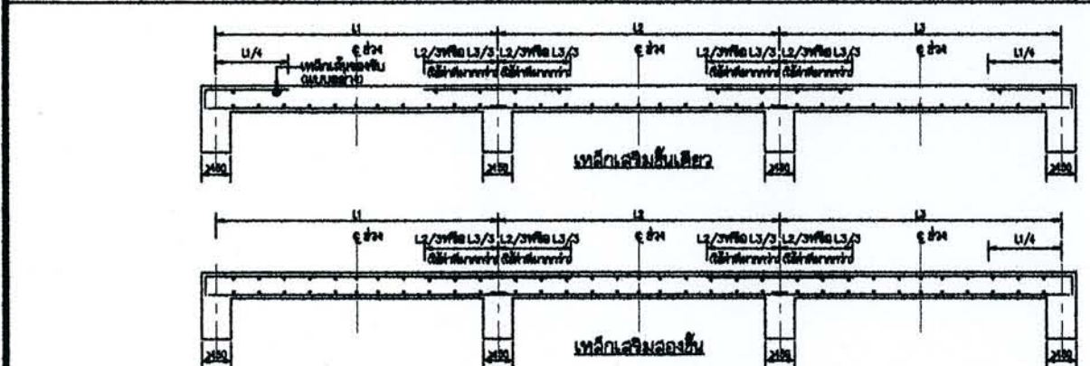
แบบมาตรฐานแสดงการเสริมเหล็กตามยาวในคานที่ฝังลงในดิน
