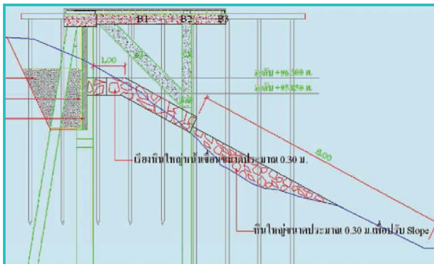
ภาพแสดงขั้นตอนงานหล่อโครงสร้างคานยึดหัวเข็ม, หล่อคาน B1,B2,B3
