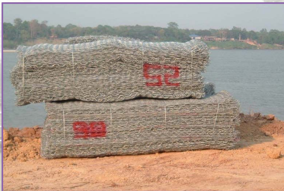
รูปกล่องแมทเทรส (ถ่ายขณะส่งถึงหน้างาน)
