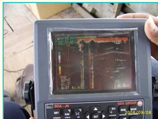
ภาพแสดงการตรวจสอบระดับท้องลำนํ้า ด้วยเครื่อง Echo Sounding
