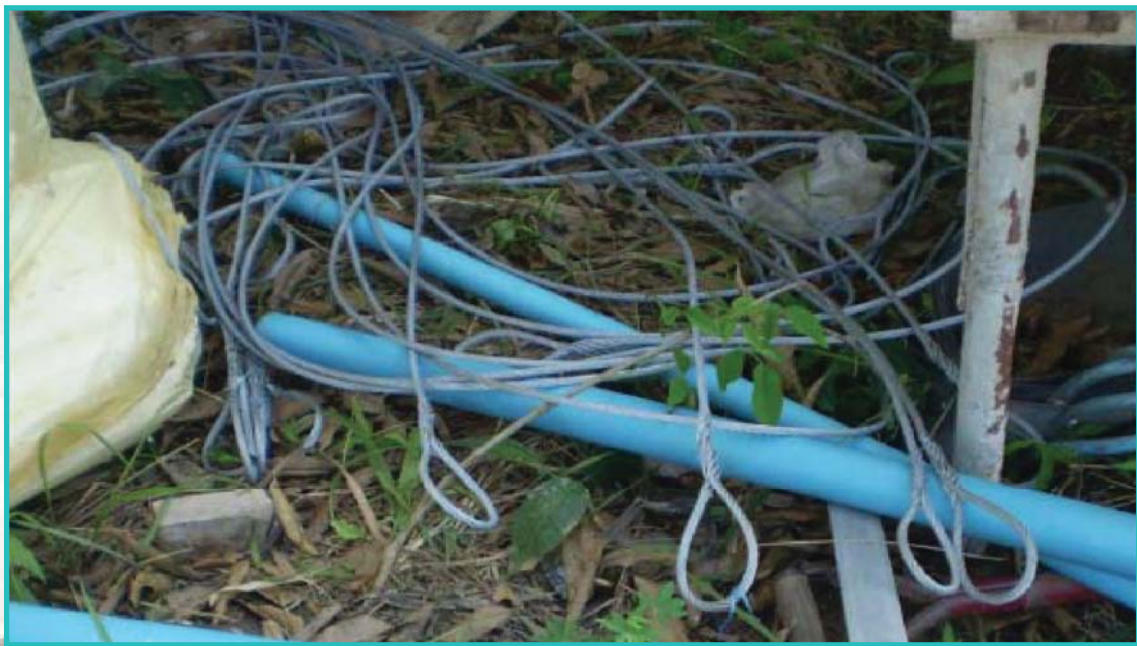
รูปแสดงสลิง 9 มม. สำหรับยกกล่องเมตรส (ปลายด้านหนึ่งถักเป็นห่วง)
