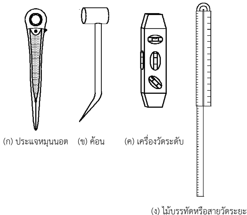
รูปที่ 28 อุปกรณ์สำหรับการติดตั้งและประกอบนั่งร้าน
