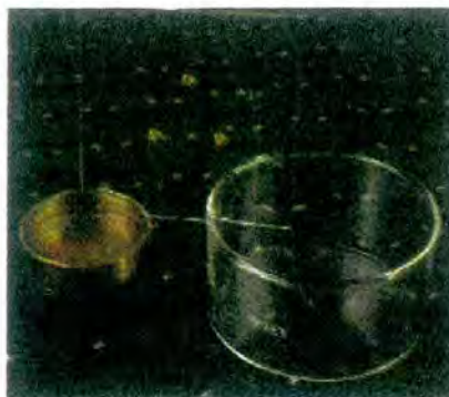
รูปที่ 16 ถ้วยสำหรับหาค่าขีดหดตัว แผ่นแก้วใสมีปุ่มโลหะ 3 ปุ่ม และถ้วยแก้ว
