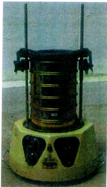
รูปที่ 3 เครื่องเขย่าและชุดตะแกรงมาตรฐานสหรัฐอเมริกา (US Standard Sieve Series)
